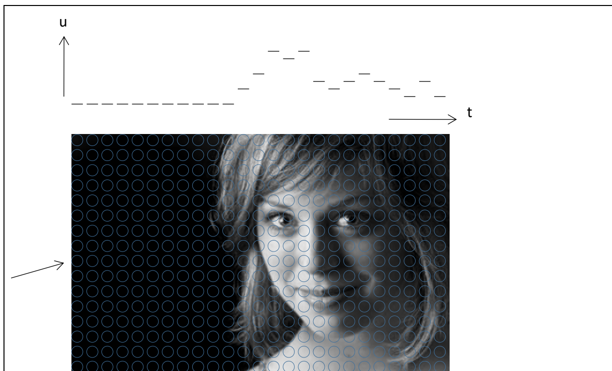
Obrázek 111: Snímání jednoho řádku obrazu v kameře
