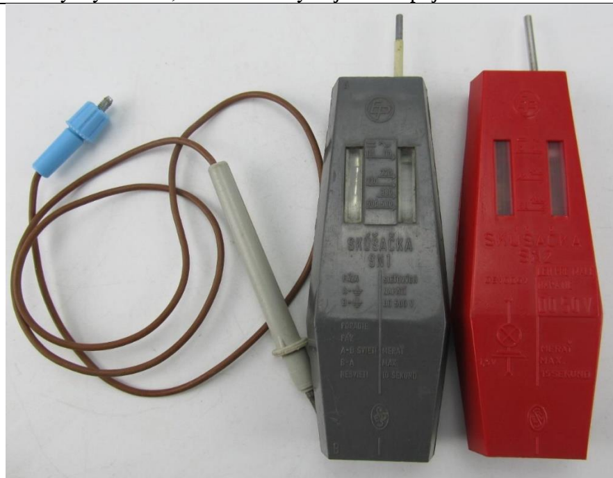
Obrázek 11: Zkoušečka „vadaska“ využívající principu vtahování jádra do cívky. Zde ani není ručka, velikost napětí odhadujeme podle pohybu jádra v průhledném okénku.
