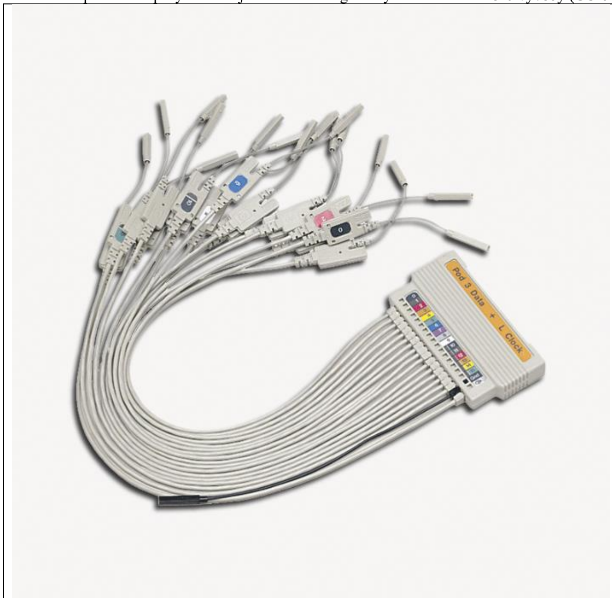
Obrázek 96: Šestnáctikanálová snímací sonda logického analyzátoru
