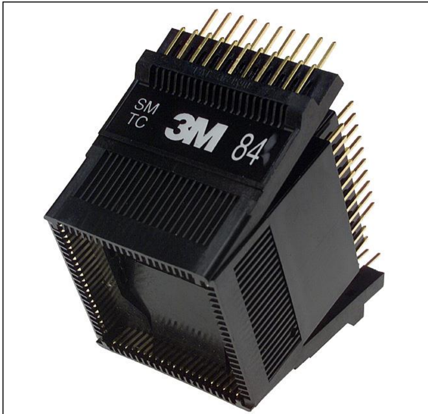
Obrázek 97: Klipsna k nasazení na integrovaný obvod s mnoha vývody
