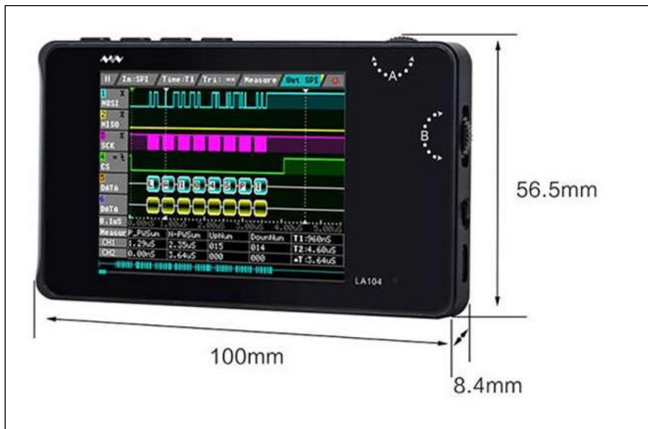
Obrázek 94: Kompaktní čtyřkanalový logický analyzátor. Zabudovaná baterie, 100 Msa/s. Cena v březnu 2023 2400 Kč
